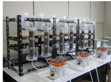
図1 ISO/TS 21268-3の試験概念図
