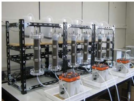
図-2 カラム通水試験装置写真<sup>2)-4)</sup>
